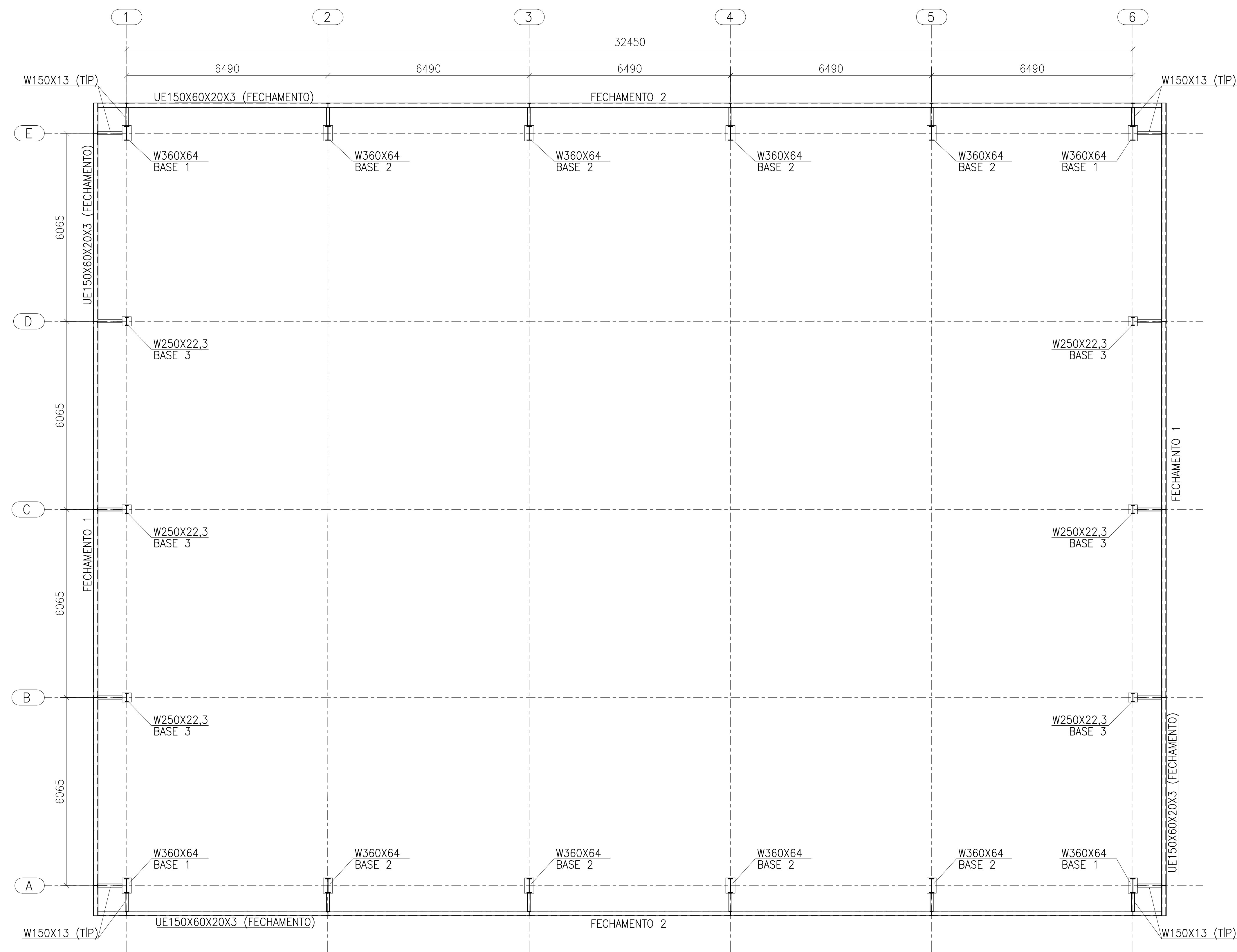
PLANO DAS BASES – TOPO PILARES DE CONCRETO ESC. 1:100
